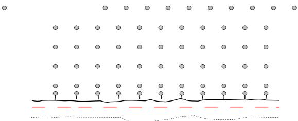
Вариант 6. Рассчитать параметры БВР для заданных условий: Вскрышной блок, высота уступа которого H=13,0м., обурен скважинами диаметром d=250мм., сетка бурения скважин шахматная. В качестве основного заряда используется ВВ «Грамфорэм – 50 АП», вместимость ВВ в 1п.м. скважины p=72,5кг/п.м., удельный расход ВВq=1,17кг/м $^3$ . В качестве промежуточ-
